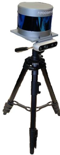
Abbildung 3.1: Verwendete Hardware, Konstruktion bestehend aus 3D-Druck, Lidar, Kamera und Kamerastativ
