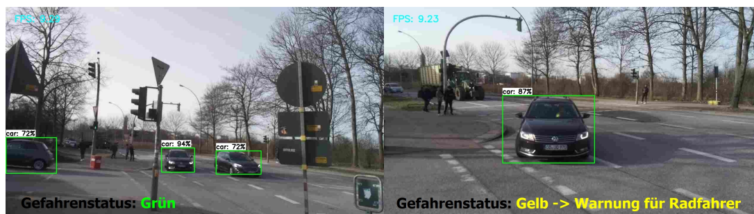
Abbildung 10: Das Bild ist ein Ausschnitt von der Testfahrt mit der Reaktion der Gefahrendetektion Anwendung in einer potenziell gefährlichen Situation
