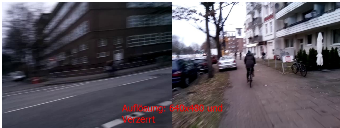
Abbildung 3: Verzerrte Aufnahmen durch kontinuierliche Bildaufnahmen
