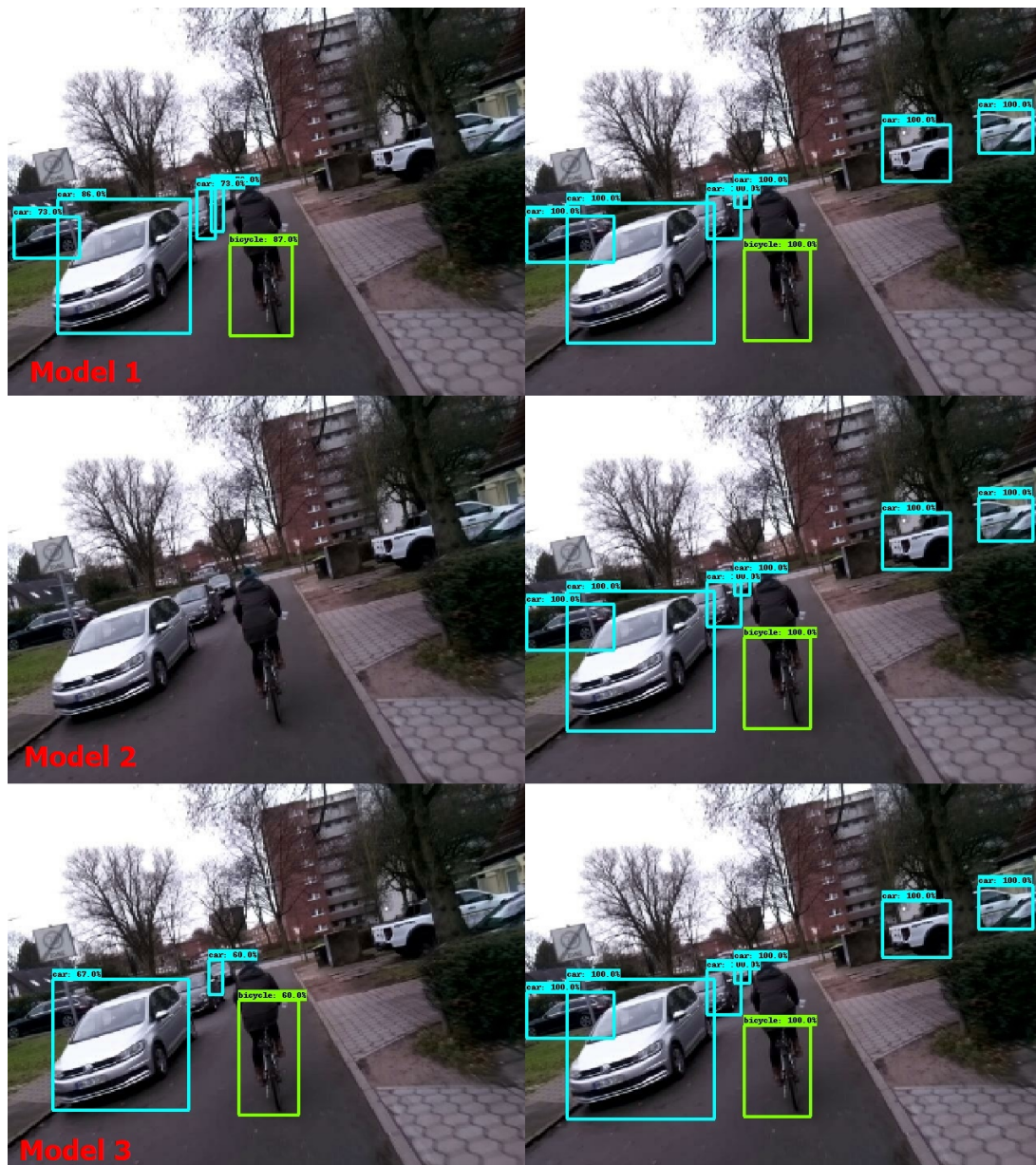
Abbildung 7: In diesem Bild sieht man den Unterschied der erwarteten, händischen Annotation und der wirklichen Detektion der trainierten Modelle
