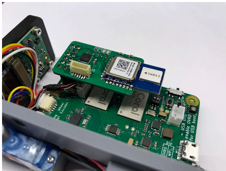
Abbildung 4.11: Pmod-Erweiterung mit IO-Expander und DWM1000 UWB-Modul
