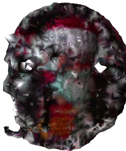
Abbildung 6.9: 3D-Modell erstellt vom Alpha Shape Algorithmus mit \alpha = 0.005
