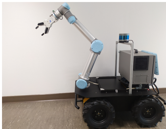
Abbildung 3.3: Plattform mit Roboterarm UR5 für Objektuntersuchung: Husky Plattform für TIQ Projekt [3]
