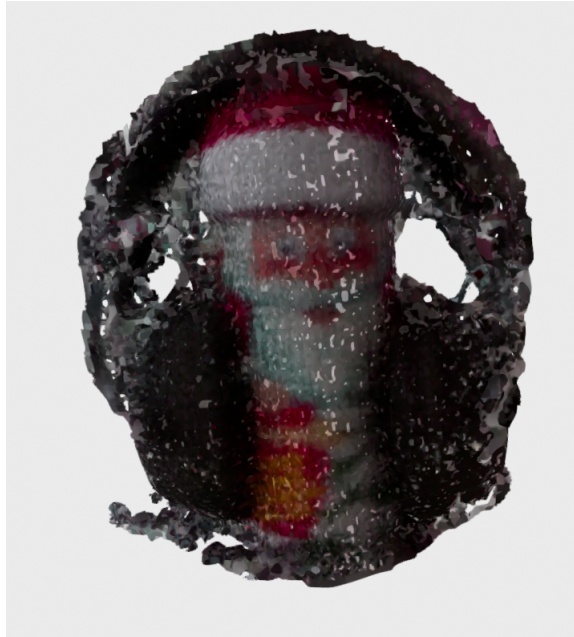
Abbildung 6.13: Poisson Modell ohne Punkten mit kleinen Punktdichten
