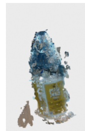
Flaschepunktwolke, die mit der Registrierung ohne Optimierung erstellt wurde
