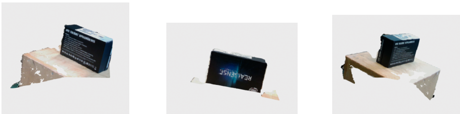
Abbildung 7.2: Drei der Punktwolken, die nach der Untersuchung von der Schachtel gespeichert wurden
