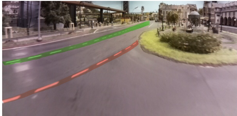
Abbildung 3.2: Leitlinie farblich grün markiert. Wartelinie mit gleichem Verhältnis Strich zu Lücke, wie Leitlinie, farblich orange markiert.
