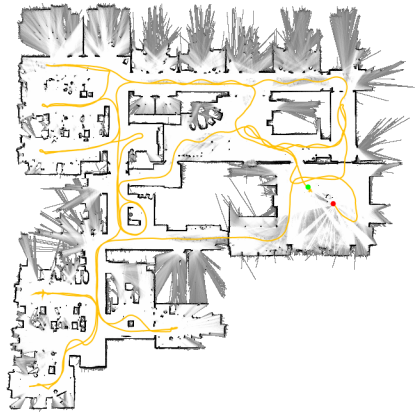
Abb. 5. Durch Cartographer generierte Karte mit Revo LDS Sensordaten. [Bildquelle [4]]
