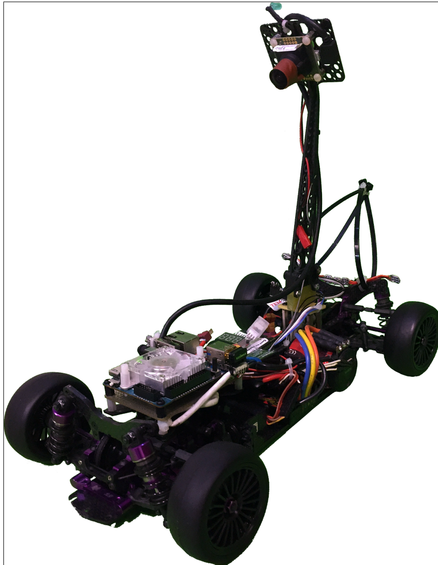
Abbildung 2.4.: Die Fahrzeugplattform „LaK-XU 5000“
