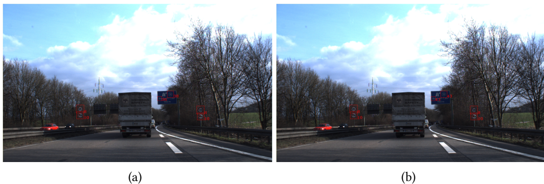
Abbildung 6.7: In Bild (b) wurde der Klassifikator mit einer zusätzlichen Hintergrund Klasse (43) trainiert. d.h. alle gefundene Objekte im Bild sind richtig identifiziert, anders als Bild (a).
