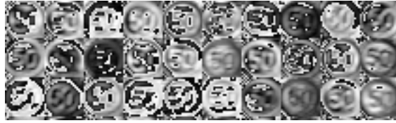
Abbildung 5.12: Die Feature Maps nach Ausführung des Max-Pooling Verfahrens
