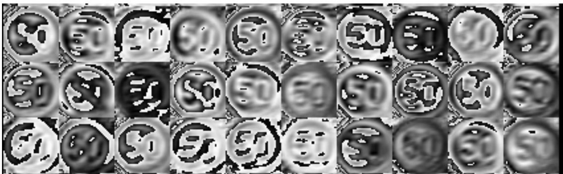
Abbildung 5.11: Beispiele Für resultierende Feature Maps der erste Konvolution
