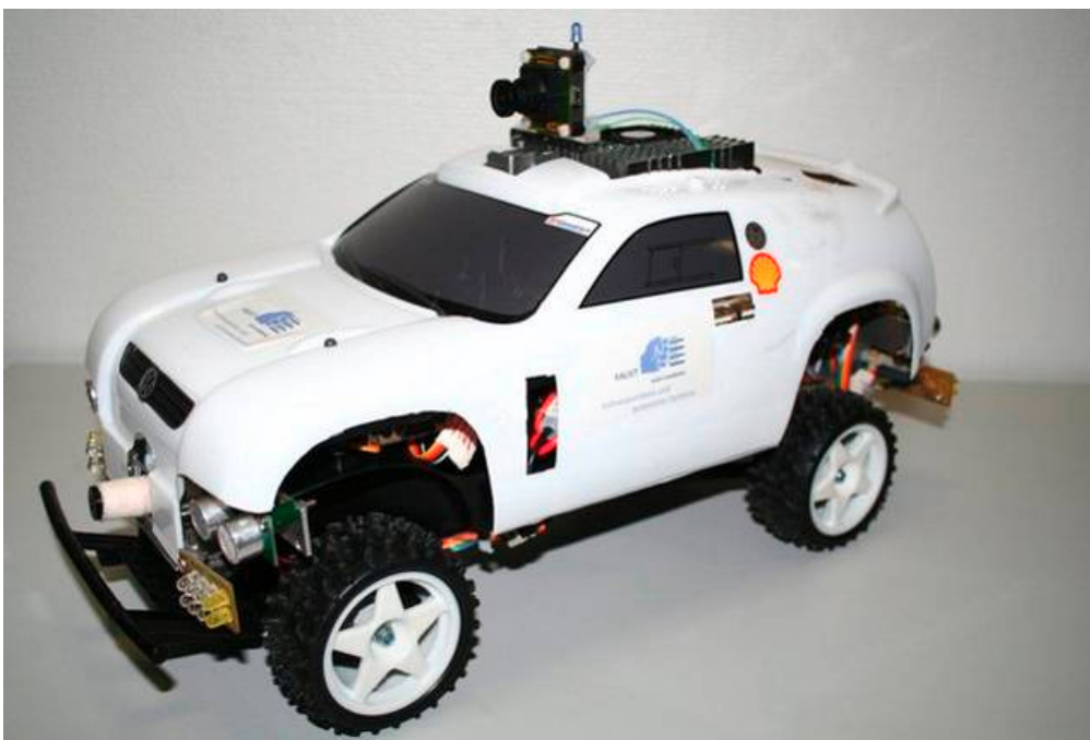
Abbildung 1: Das Modellfahrzeug Nebula mit Kamera und Embedded-PC
