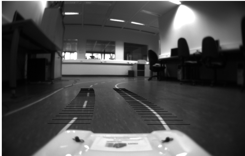
Abbildung 6: Fahrspurerkennung durch Polaris
